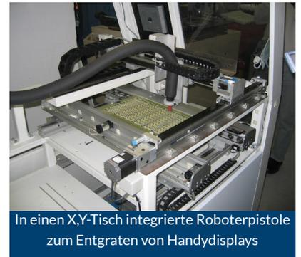
In einen XY-Tisch integrierte Roboterpistole zum Entgraten von Handydisplays
