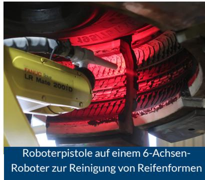
Roboterpistole auf einem 6-Achsen-Roboter zur Reinigung von Reifenformen
