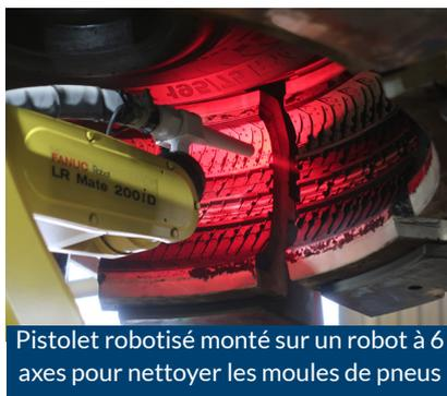
Pistolet robotisé monté sur un robot à 6 axes pour nettoyer les moules de pneus
