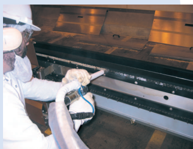
Pulizia di meccanismi a catena
