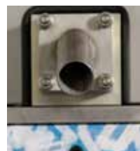
Cambio rápido de placas de extrusión con 4 pernos
