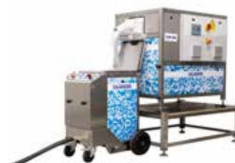
Los equipos de tiro de hielo seco se pueden rellenar directamente con hielo seco
