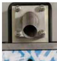
Changement rapide de matrice avec 4 boulons
