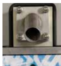
Changement rapide de matrice avec 4 boulons
