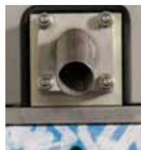
Rutsche leicht über 4 Schrauben abnehmbar
